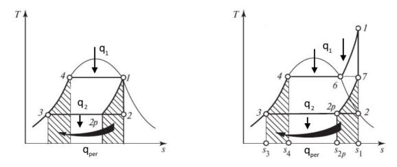
Коэффициент полезного действия цикла Ренкина с перегревом пара даже в случае предельной регенерации будет меньше термического КПД цикла Карно, осуществляемого в том же интервале температур, однако при этом термический КПД цикла Ренкина заметно возрастает (по сравнению с циклом без регенерации).
