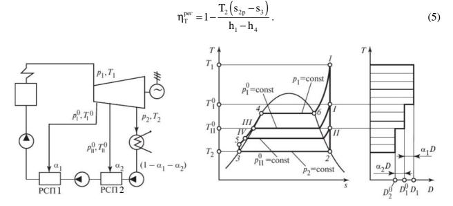
В реальных паросиловых циклах регенерация осуществляется с помощью регенеративных, поверхностных или смешивающих теплообменников, в каждый из
