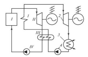
В ртутном котле I к ртути подводится теплота, ртуть испаряется, и сухой насыщенный пар ртути при давлении  $p_1^{p\tau}$  поступает в ртутную турбину II, где он совершает работу, отдаваемую соединенному с этой турбиной электрогенератору. На выходе из турбины отработавший ртутный пар, имеющий давление  $p_2^{p\tau}$ , направляется в конденсатор-испаритель III, где он конденсируется, и затем жидкая ртуть насосом IV подается в котел I.
