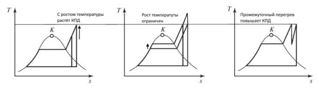
Одним из способов, позволяющих снизить влажность пара на выходе из турбины, является перегрев пара. Применение перегрева пара приводит к увеличению термического КПД цикла и одновременно приводит к более высоким степеням сухости пара.
