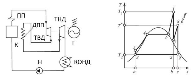
Цикл с промежуточным перегревом пара можно представить себе состоящим из двух отдельных циклов - обычного цикла Ренкина (основного) 5-4-6-1-2-3-5 и дополнительного цикла 2-7-8-9-2 (здесь 7-8 – изобара  $p^* = const$ ). При этом формально можно считать, что работа, произведенная на участке 7-2 адиабаты расширения в основном цикле, затрачивается на адиабатное сжатие рабочего тела на участке 2-7 дополнительного цикла.
